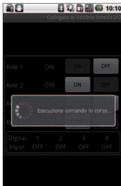
Fig. 5 – El envío del comando vía Bluetooth a la tarjeta.
