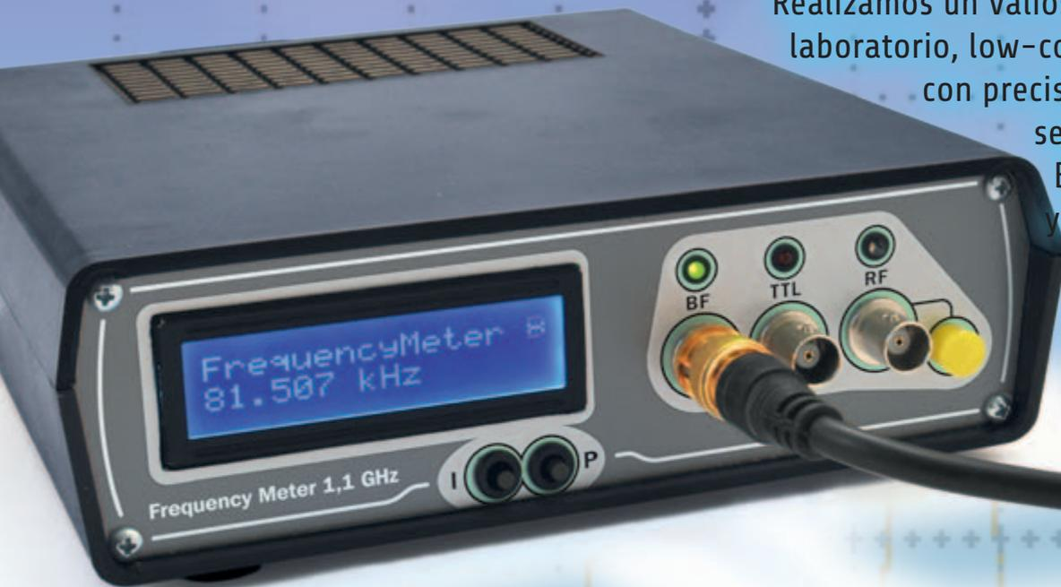
Realizamos un valioso instrumento para laboratorio, low-cost y capaz de medir con precisión la frecuencia de señales analógicas de BF hasta 10 MHz, TTL y CMOS hasta 50 MHz, pero también componentes de radiofrecuencia hasta 1,1 GHz. Primera parte.
