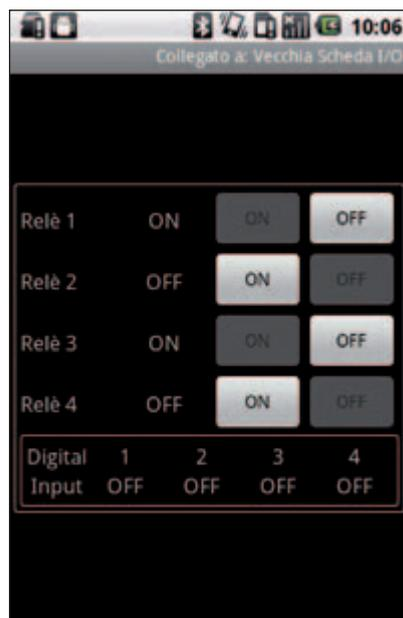
Fig. 4 – La ventana resume el estado de las entradas y los relés.
