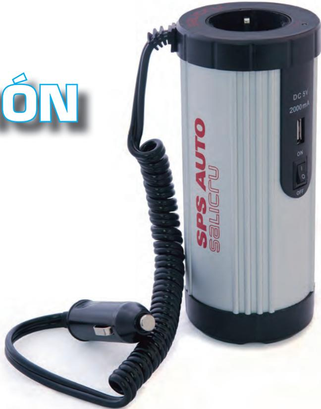
La conexión de entrada se realiza a través de la toma encendedor del coche (o embarcación) y la salida a 230 VAC es tipo **schuko** con una potencia de 150 W, mientras que la salida a 5 VDC es mediante un puerto USB de 2 A de carga, que permite alimentar directamente pequeños dispositivos como **smartphones** o **tablets**.
