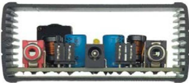
**Fig. 17** Foto del amplificador hecho para nuestra prueba laboratorio, insertado en chásis de metal preparado especialmente para ellos. Arriba, el circuito en el chásis y visto en la sección delantera y trasera.
