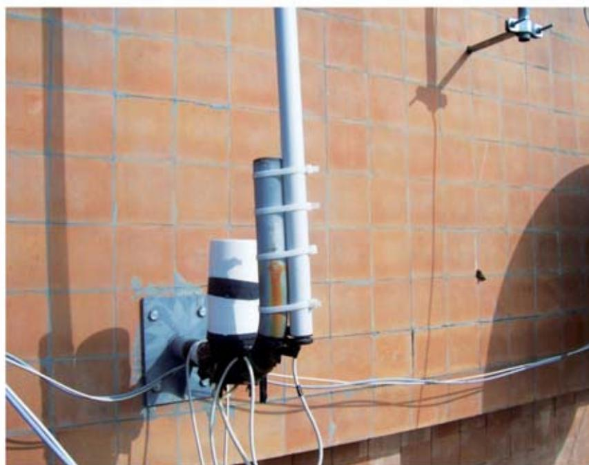
*Fig. 6 Así hemos resuelto el problema de la fijación del tubo que contiene el amplificador.*
