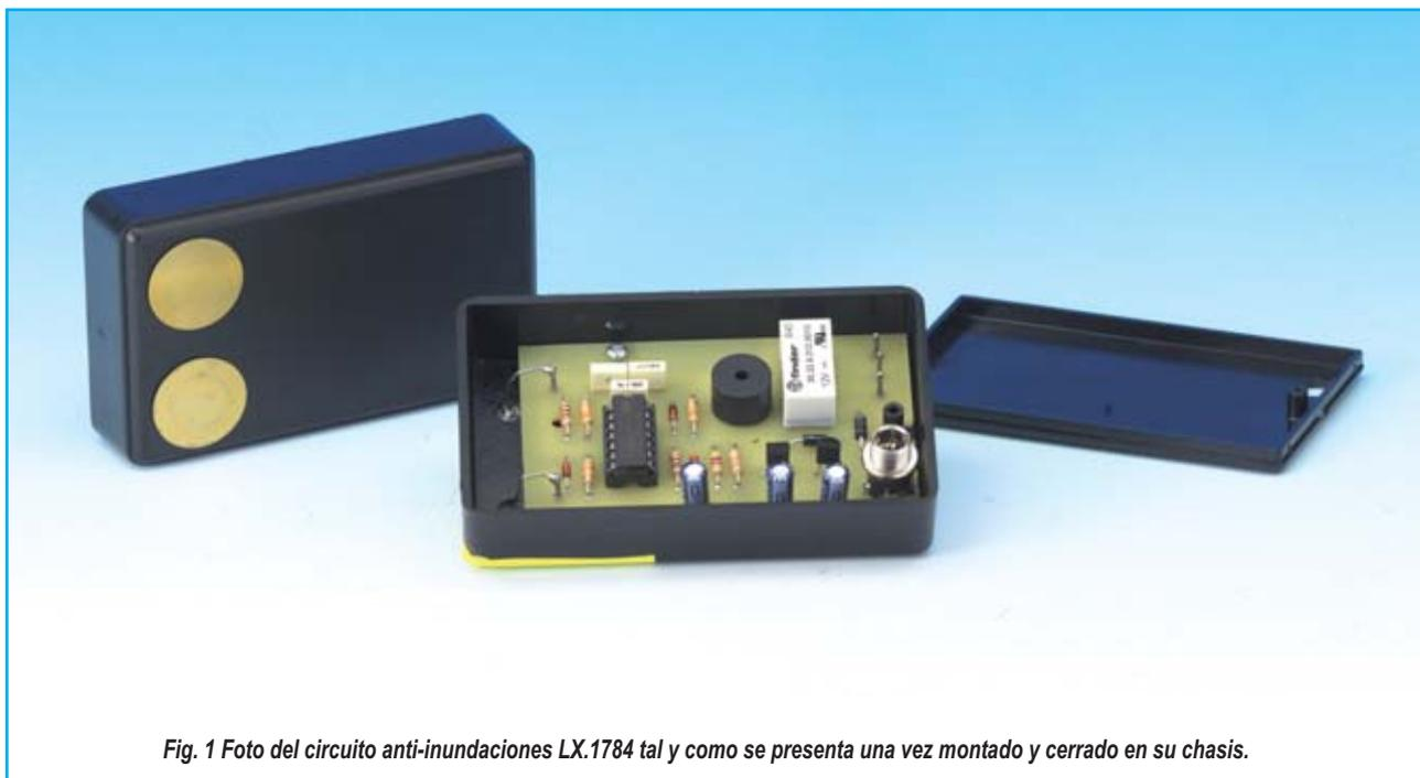
Fig. 1 Foto del circuito anti-inundaciones LX.1784 tal y como se presenta una vez montado y cerrado en su chasis.
