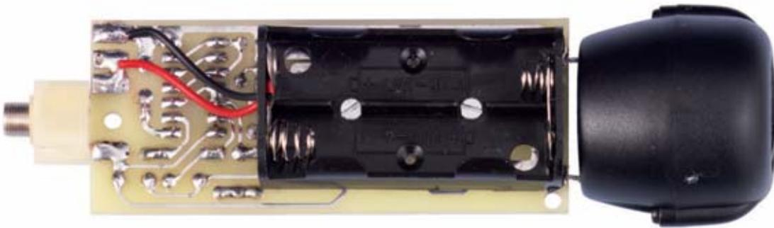
**Fig.10** Fijando un cordoncito dentro del jack, bastará con tirar de él para activar la sirena y encender el diodo flash.
