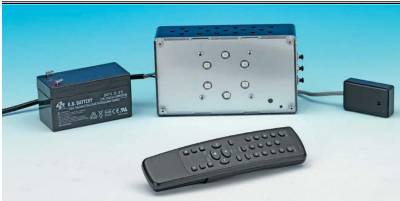
**Fig.24** la foto muestra la lámpara de emergencia con el montaje finalizado. En este caso se ha utilizado una batería de 12 voltios/1,2 Ah, pero a la lámpara también puede conectarse una batería común de plomo.
