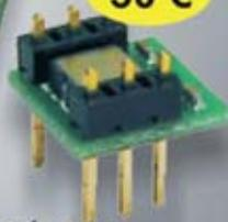
Acelerómetro de 2 ejes 28017
