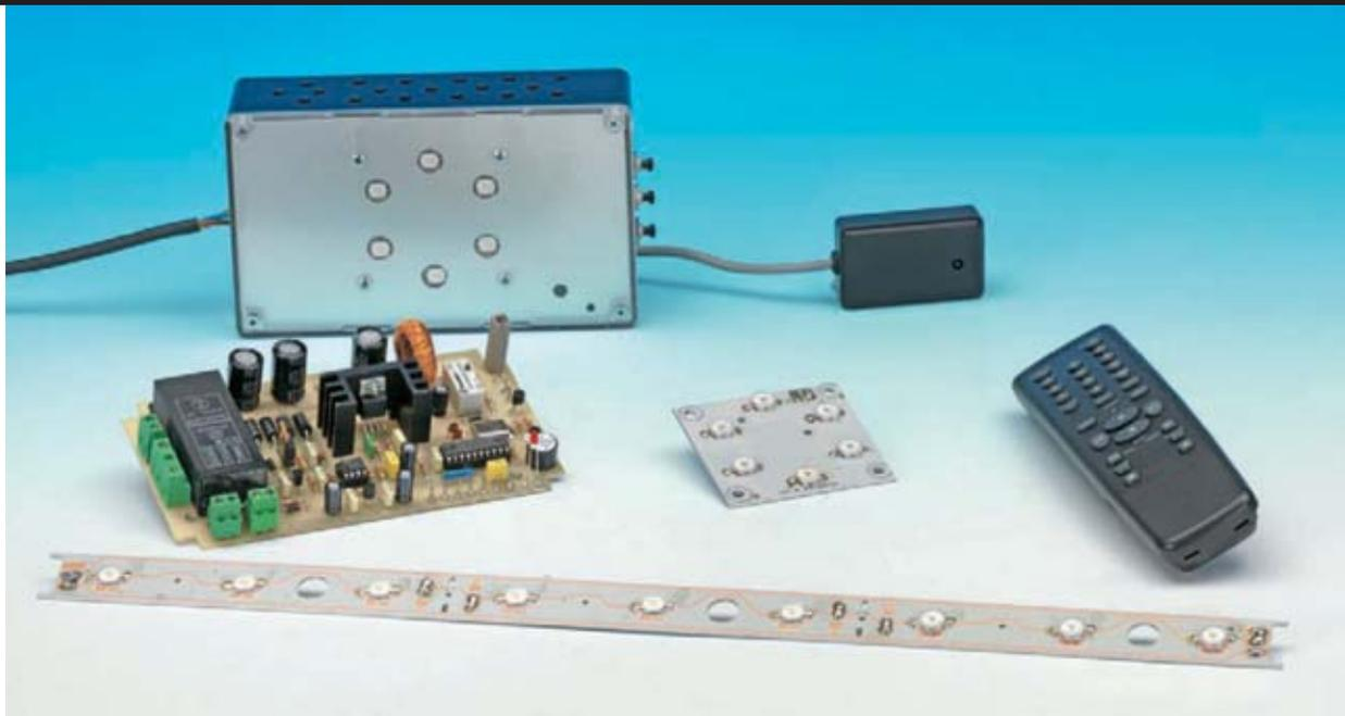
**Fig.1 en la foto se puede ver el alimentador de microcontrol por diodos led LX.1758 con un sensor infrarrojo, la barra luminosa de 9 diodos led, el faro spot de 6 diodos led y la lámpara de emergencia con el montada.**
