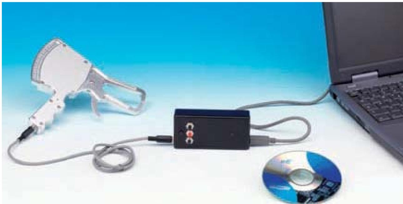
**Fig.1 en la fotografía se puede ver la tarjeta USB KM1734K, la pinza para comprobar los pliegues de la piel y el CD-Rom, con el que podréis realizar la medición de la masa gorda siguiendo las indicaciones que os suministramos en el artículo.**
