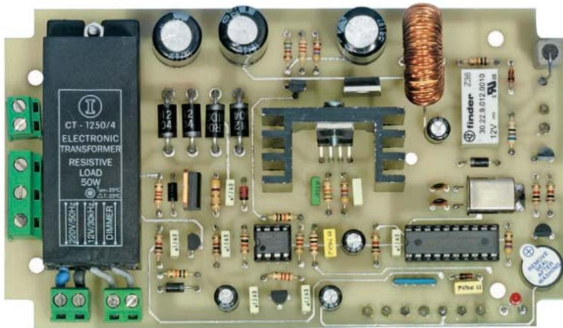
**Fig.14** he aquí como se presenta el circuito impreso una vez terminado el montaje. Arriba a la derecha se puede ver la resistencia de current sense. Instalar la resistencia de current sense adecuada, al utilizar tanto el faro spot de 6 led como la barra luminosa de 9 led.
