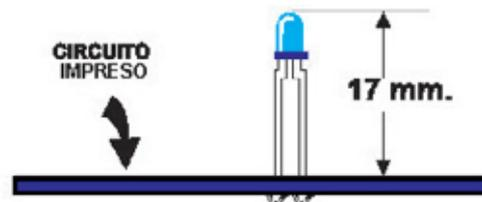
Fig.7 antes de soldar los dos terminales de diodo led DL1 en el circuito impreso, controlad que su cuerpo este a 17mm de distancia de él.
