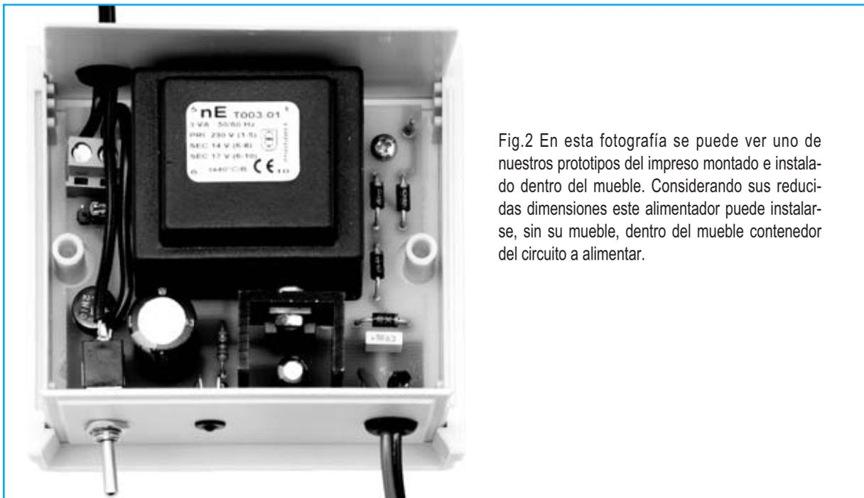
Fig.2 En esta fotografía se puede ver uno de nuestros prototipos del impreso montado e instalado dentro del mueble. Considerando sus reducidas dimensiones este alimentador puede instalarse, sin su mueble, dentro del mueble contenedor del circuito a alimentar.
