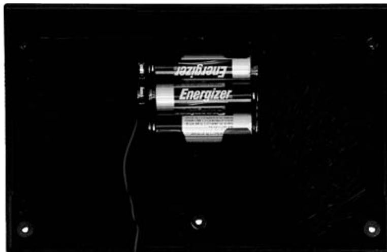
Fig.5 En la base del mueble plástico hay que fijar el portapilas utilizando pegamento rápido. En su interior hay que instalar 3 pilas de 1,5 voltios tipo AAA, teniendo mucho cuidado en respetar la polaridad (+/-).
