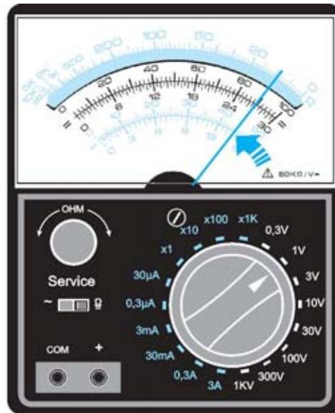
Fig.10 Para determinar el valor de las frecuencias mínima y máxima (F1-F2) a -3 dB hay que utilizar los botones + - del panel del Generador DDS hasta que el téster indique un valor de 0,87 voltios.
