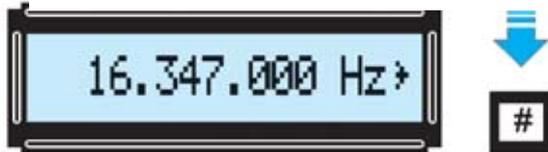
Fig.26 Una vez tecleado el valor requerido hay que presionar la tecla # para obtener la señal en la salida del Generador DDS. En la parte derecha del display LCD se muestra el símbolo > como confirmación.
