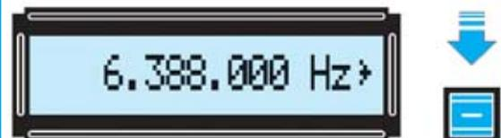
Fig.20 Para ajustar con una mayor precisión la frecuencia de sintonía conviene operar con las unidades de millar de Hz. Una vez seleccionado el cuarto dígito hay que accionar el botón - del panel hasta leer 6.388.000 Hz.
