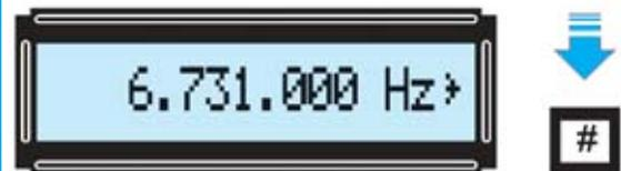
Fig.17 Una vez tecleado el valor requerido hay que presionar la tecla # para obtener la señal en la salida del Generador DDS. En la parte derecha del display LCD se muestra el símbolo > como confirmación.
