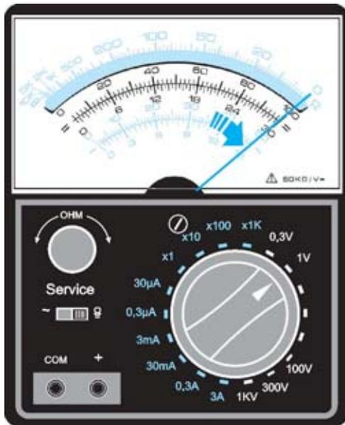
Fig.9 Una vez obtenida la frecuencia de sintonía exacta hay que predisponer el téster a un alcance de 1 voltio CC. A continuación hay que ajustar el potenciómetro R5 (ver Fig.1) para obtener una lectura exacta de 1 voltio.
