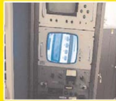
**Fig.2** Para controlar la precisión del contador Geiger y para determinar la sensibilidad del instrumento se ha utilizado Cesio 137, elemento que emite radiaciones gamma con una energía de 662 keV. De esta forma el contador ha sido ajustado para proporcionar lecturas en microSievert referidas a este radioisótopo.
