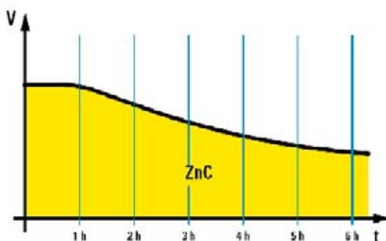
**Fig.2** En este gráfico se muestra como la capacidad de proporcionar corriente en un ciclo normal de trabajo por parte de pilas galvanizadas con cinc y carbono decrece progresivamente en el tiempo.
