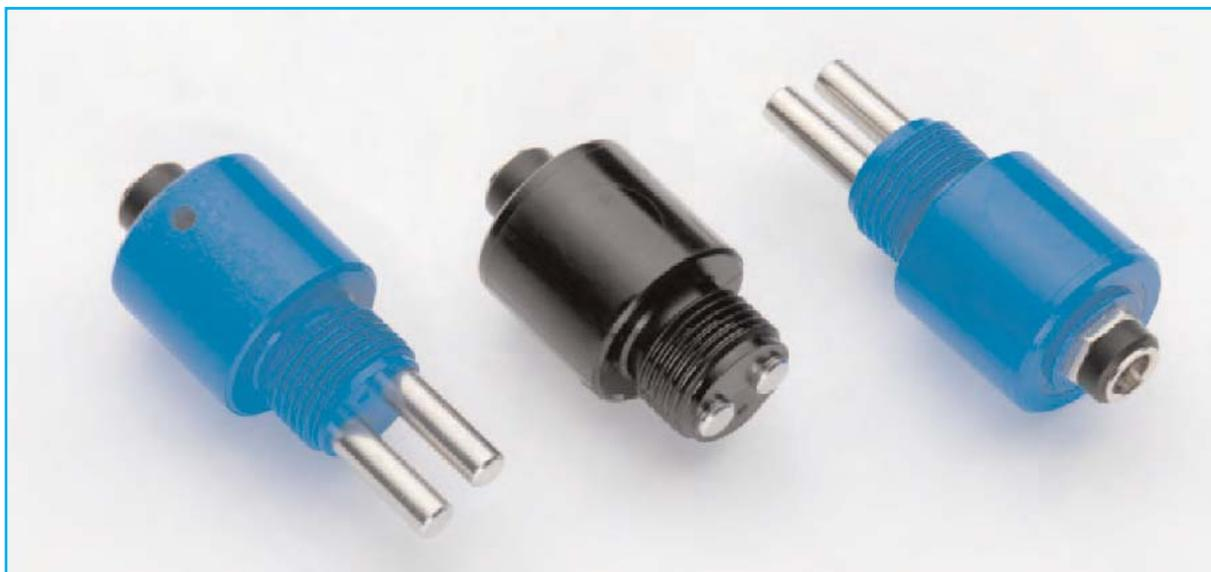
**Fig.1** Celdas K1 y K5 para el Conductivímetro LX.1697. La celda K5, de color azul, se utiliza para aguas oligominerales o poco mineralizadas, mientras que la celda K1, de color negro y con los electrodos más cortos, debe utilizarse para aguas muy saladas, esto es para medidas superiores a 1.000 uS/cm.
