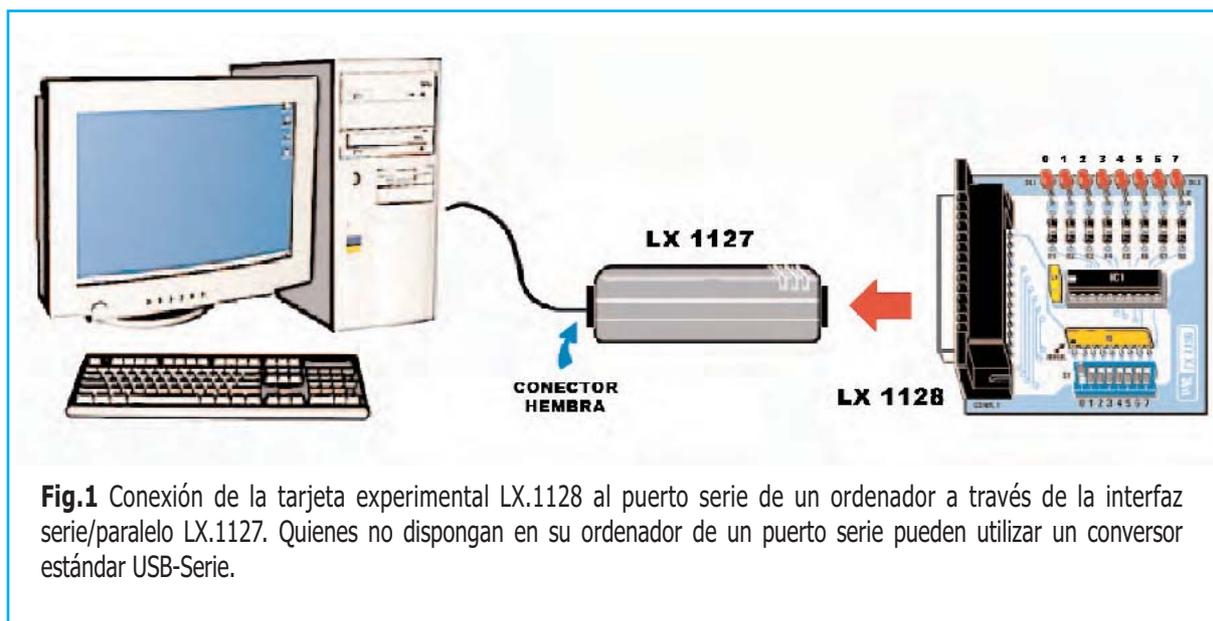
**Fig.1** Conexión de la tarjeta experimental LX.1128 al puerto serie de un ordenador a través de la interfaz serie/paralelo LX.1127. Quienes no dispongan en su ordenador de un puerto serie pueden utilizar un conversor estándar USB-Serie.
