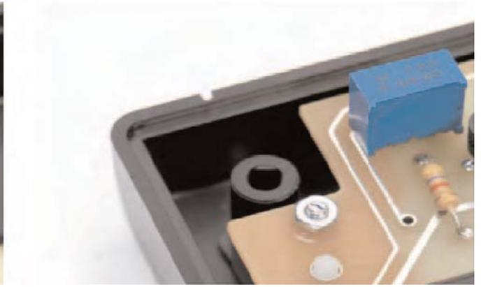
**Fig.16** Hay que posicionar el circuito sobre el separador y fijarlo mediante una tuerca.
