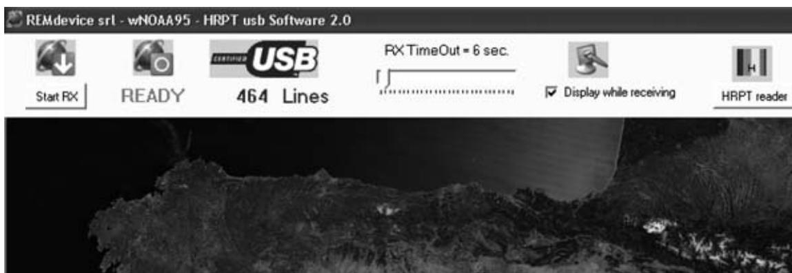
Fig.19 Cuando aparece la indicación READY significa que el receptor no está recibiendo señal del satélite y que está LISTO para el siguiente paso.
