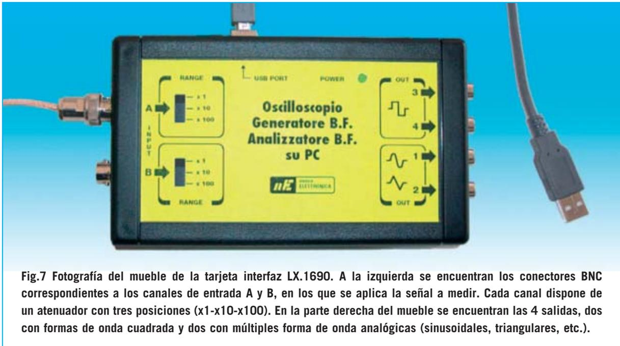
Fig.7 Fotografía del mueble de la tarjeta interfaz LX.1690. A la izquierda se encuentran los conectores BNC correspondientes a los canales de entrada A y B, en los que se aplica la señal a medir. Cada canal dispone de un atenuador con tres posiciones (x1-x10-x100). En la parte derecha del mueble se encuentran las 4 salidas, dos con formas de onda cuadrada y dos con múltiples forma de onda analógicas (sinusoidales, triangulares, etc.).
