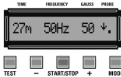
Fig.28 Para iniciar la magnetoterapia hay que presionar el pulsador **START/STOP**. La flecha situada en la parte derecha del display indica que el aparato funciona correctamente.
