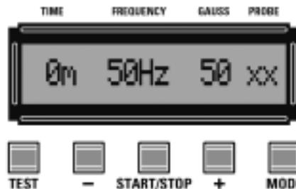
Fig.29 Cuando se cumple el tiempo programado en el display aparecen dos **XX**. El zumbador emite una señal acústica.
