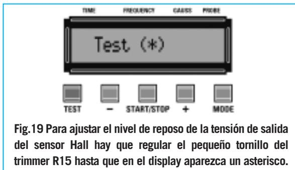
Fig.19 Para ajustar el nivel de reposo de la tensión de salida del sensor Hall hay que regular el pequeño tornillo del trimmer R15 hasta que en el display aparezca un asterisco.
