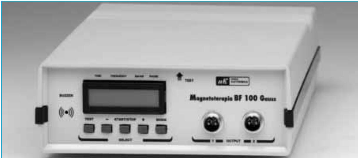
Fig.30 Aspecto de la magnetoterapia BF a 100 gauss una vez concluido su montaje. Mediante los cinco pulsadores se ajustan todos los parámetros necesarios para el funcionamiento del dispositivo. Para determinar la polaridad de los solenoides se han de apoyar sobre la tapa en correspondencia con la flecha TEST.
