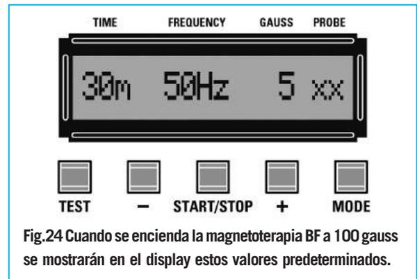
Fig.24 Cuando se encienda la magnetoterapia BF a 100 gauss se mostrarán en el display estos valores predeterminados.
