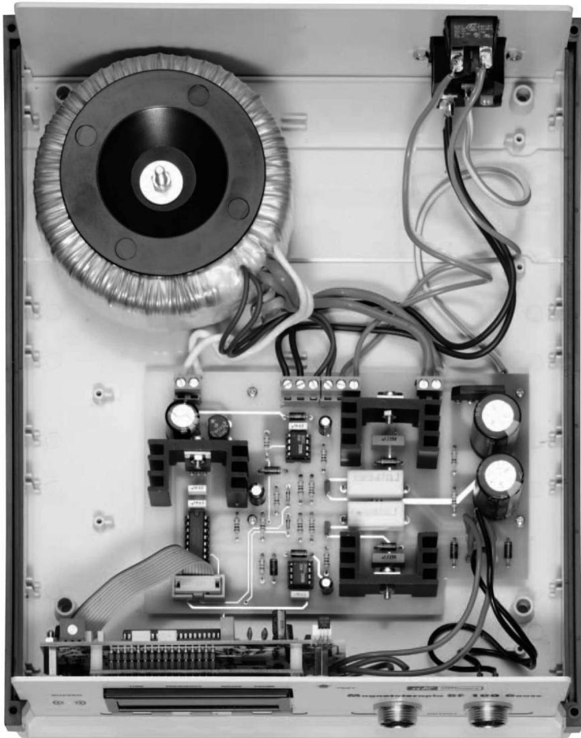
Fig.17 Fotografía de la circuitería electrónica instalada dentro del mueble. Hay que prestar especial atención al realizar el cableado entre la etapa de potencia y el transformador toroidal, controlando las etiquetas del transformador, ya que los colores de los cables del primario y de los secundarios podrían no corresponder a los mostrados en esta fotografía.
