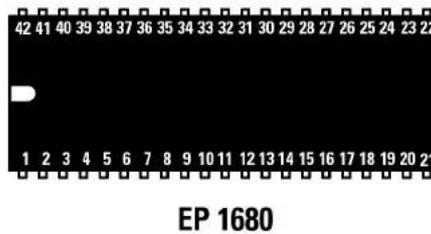
Fig.7 Conexiones, vistas desde arriba, del microcontrolador ST72C334. Este componente lo proporcionamos programado (referencia EP1680) para desarrollar todas las funciones necesarias para el funcionamiento de la magnetoterapia.
