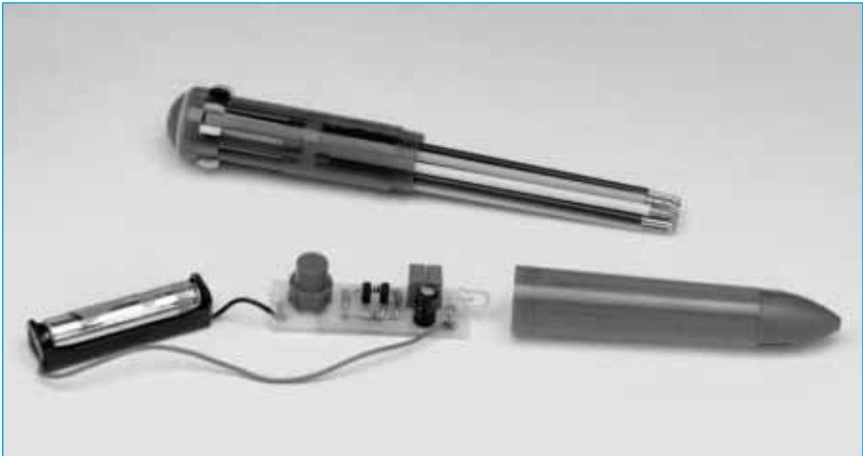
Superando el valor de la tensión directa del diodo LED la corriente puede circular y excitar el LED, que vemos **encendido** de forma **uniforme** debido a la persistencia visual de la imagen en la retina del ojo. En realidad el **diodo LED** se enciende con **picos de tensión** a una frecuencia de **90 KHz**.
