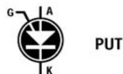
Fig.1 Símbolo eléctrico del PUT (Programable Unijunction Transistor). A diferencia del tiristor (ver Fig.2), su puerta (G) se encuentra en la parte superior, al lado del Ánodo (A).
