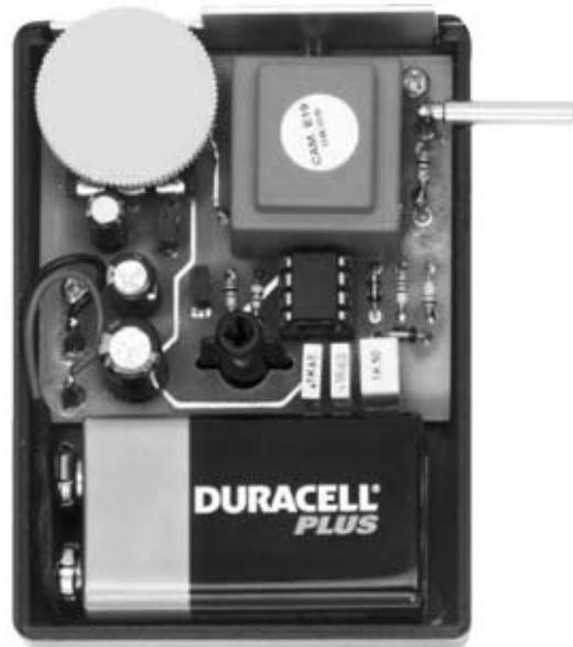
Ya se puede montar el **transformador TM1** que, como notaréis, solo se puede instalar de una única forma. Una vez finalizado el montaje de los componentes se puede proceder a instalar, en su correspondiente **zócalo**, el integrado **IC1**, orientando su muesca de referencia en forma de **U** hacia el transformador.
