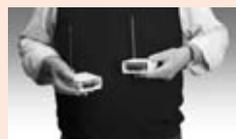
Con los módems inteligentes que aquí presentamos podréis transmitir y recibir datos vía radio eliminando la utilización de cables de conexión entre el periférico y el ordenador. En este artículo explicamos también la forma de conectar la Estación meteorológica KM100 al ordenador sin necesidad de utilizar cables.
