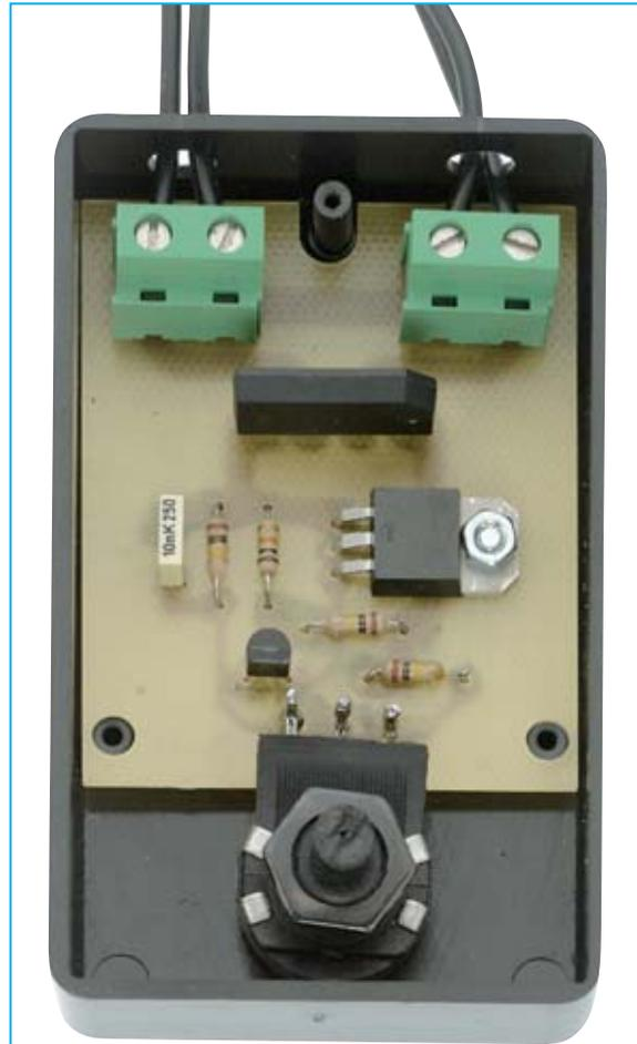
Fig.20 Una vez completado el montaje el circuito debe fijarse dentro del mueble de plástico con los tornillos incluidos en el kit. El potenciómetro también puede fijarse en la tapa del mueble.
