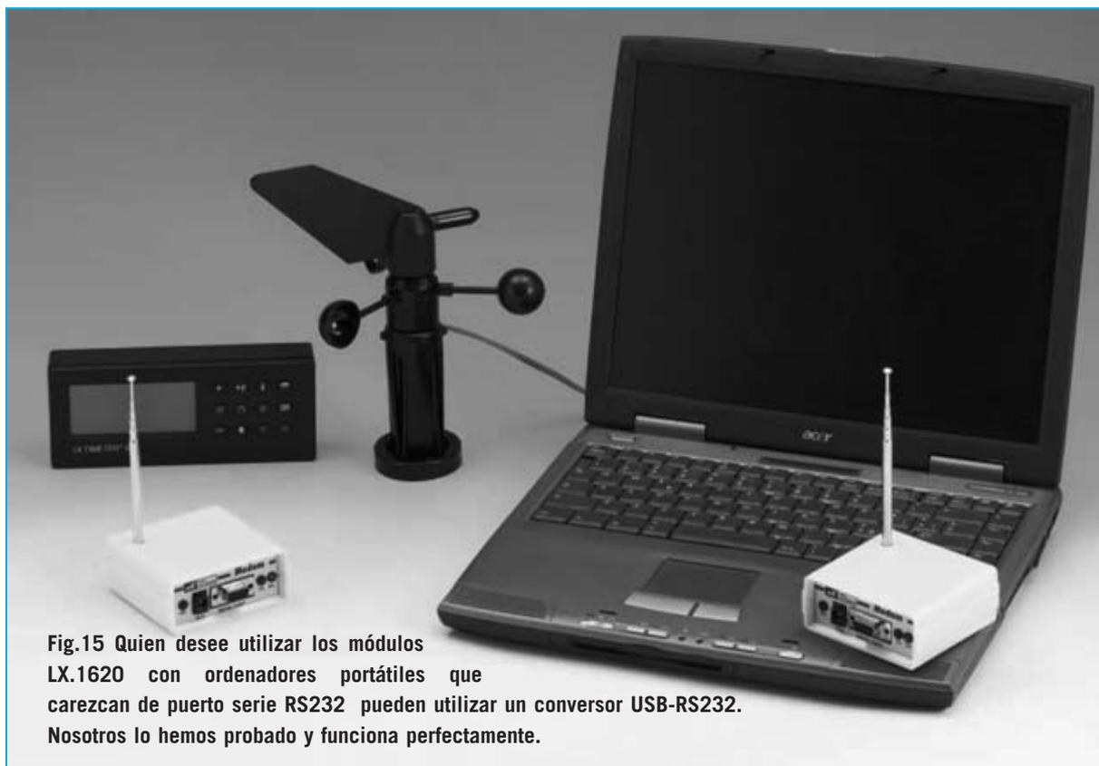
Fig.15 Quien desee utilizar los módulos LX.1620 con ordenadores portátiles que carezcan de puerto serie RS232 pueden utilizar un conversor USB-RS232. Nosotros lo hemos probado y funciona perfectamente.
