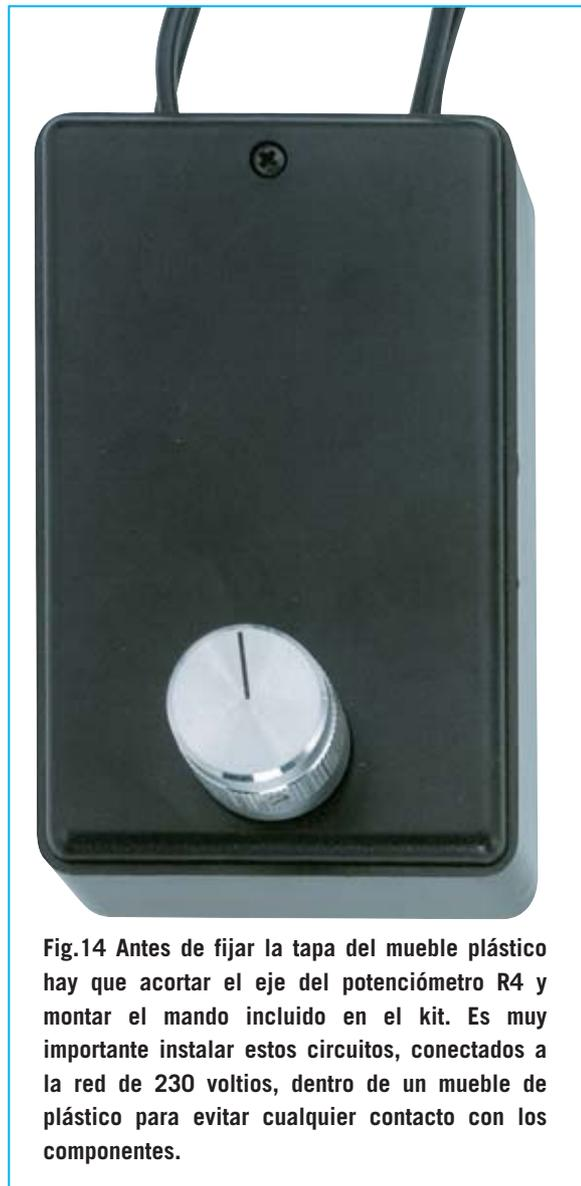
**Fig.14** Antes de fijar la tapa del mueble plástico hay que acortar el eje del potenciómetro **R4** y montar el mando incluido en el kit. Es muy importante instalar estos circuitos, conectados a la red de 230 voltios, dentro de un mueble de plástico para evitar cualquier contacto con los componentes.
