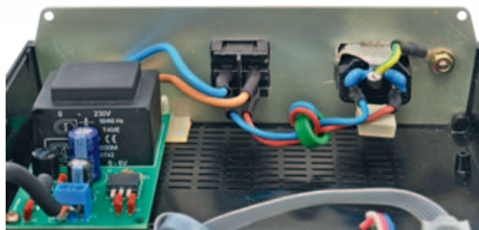
Fig. 3 - Fijación de los tres PCB en la caja.
