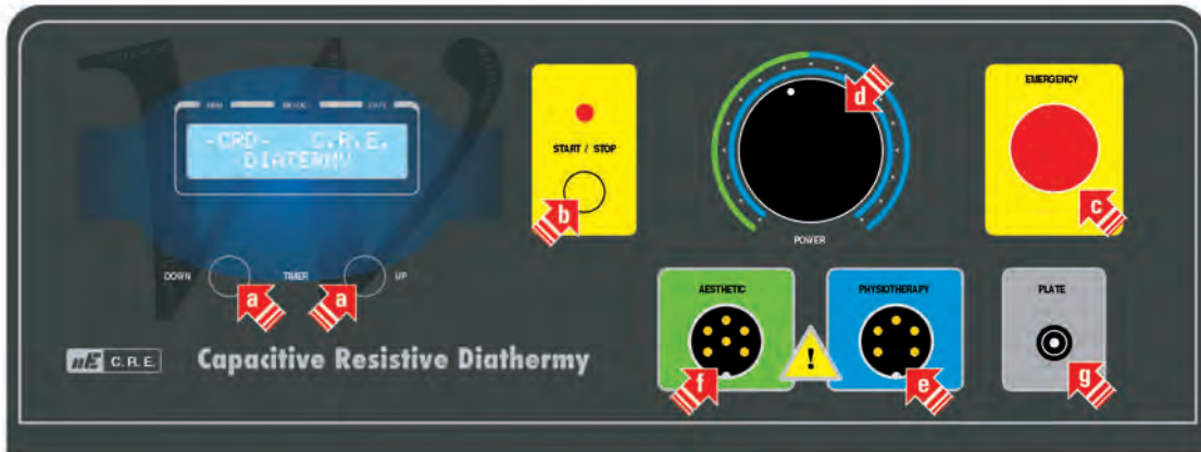
Fig.16 En el dibujo se reproduce el embellecedor frontal del DCR. En el instrumento para uso médico la línea verde situada encima del mando de potencia indica el valor máximo que no debe sobrepasarse cuando se utiliza en el campo estético. En el instrumento para uso estético el conector Physiotherapy no está conectado, y hay una gestión diferente de la potencia. A continuación se muestran las diferentes funciones del instrumento:
