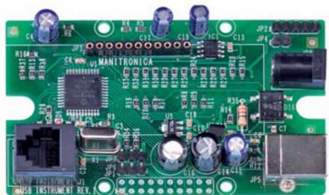
Fig. 3 Foto de la tarjeta del interfaz USB que proporcionamos ya probada y ensamblada con componentes SMD y probado.
