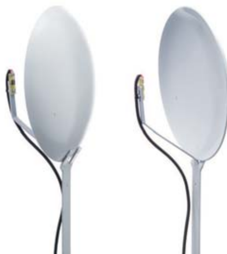
Fig.9 para facilitar de montaje os suministramos el micrófono de ultrasonidos en SMD, ya montado en el impreso. Vuestro deber será el de realizar el cableado en la entrada que va en la toma del micrófono, y fijad la parábola en su lugar respectivo del impreso, fijando el cable por medio de un trozo de celo. Naturalmente el micrófono deberá quedar direccionado hacia el foco de esta última.
