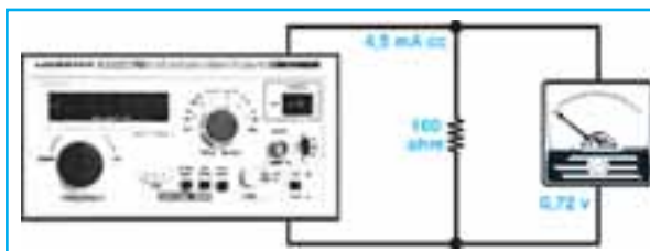
Fig.1 Cuando circula por una resistencia de 160 ohmios una corriente de 4,5 mA, la tensión en sus extremos será de (4,5 \times 160) : 1,000 = 0,72 voltios.
