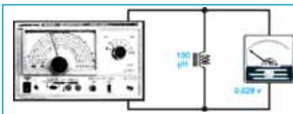
Fig.4 Para medir una tensión en los terminales de una inductancia será necesario aplicar una corriente alterna de frecuencia y corriente fija. En el caso de una inductancia de 100 microHenrios se medirán 0,028 voltios.
