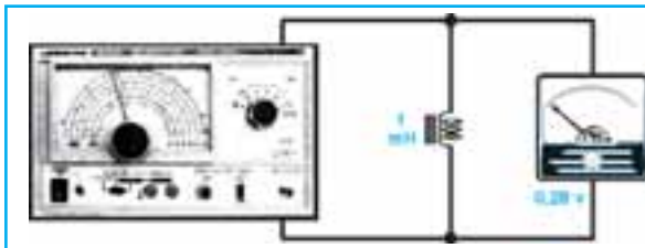
Fig.5 Si la inductancia conectada al generador BF es de 1 miliHenrio, le aplicamos una señal de 10 KHz y una corriente de 4,5 mA, en sus extremos mediremos una tensión de 0,28 voltios.
