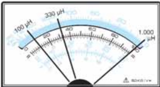
Fig.17 Para calibrar los otros dos rangos, cambiaremos el conmutador S1 a la posición de 1 miliHenrio, conectaremos una inductancia de 1K y giraremos el trimmer R6 hasta desviar la aguja al final de la escala. Recordamos que 1 miliHenrio corresponde a 1.000 microHenrios.
