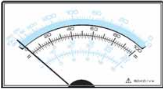
Fig.15 Si se utiliza para la lectura un tester analógico, lo conmutaremos al rango de 1 voltio DC y emplearemos para la lectura la escala de 0 a 100, de forma que resultará más fácil la medida de las escalas de 1-10-100 mili henrios de fondo de escala.
