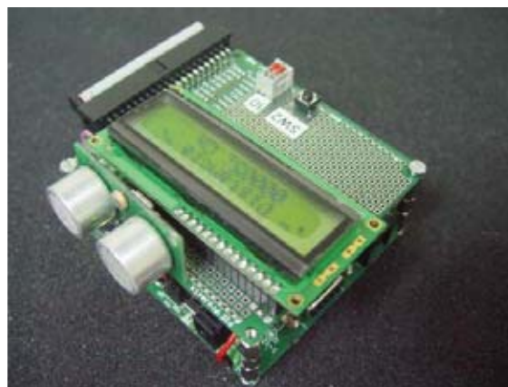
Fig.17 En la parte superior se aprecia la PIC'PROJECT con el módulo SFR08 y la pantalla LCD. La tarjeta PIC'CONTROL se encuentra debajo sujeta a la anterior mediante separadores.
