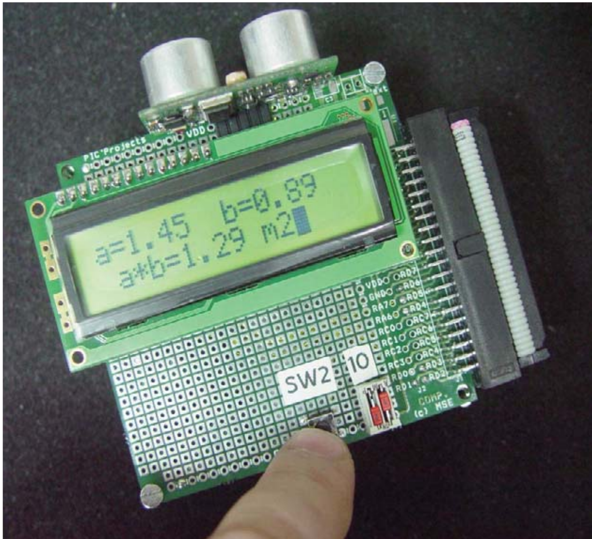
Fig.22 Primero se mide el lado "a", luego el "b" y en la pantalla LCD se visualizan ambas medidas y el valor del área "a x b" en metros cuadrados.
