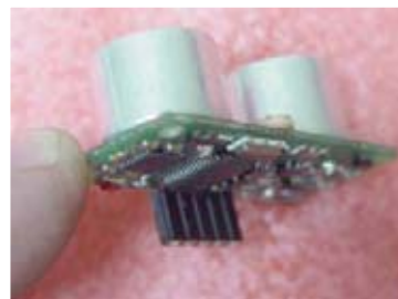
Fig.13 Se suelda un trozo de 5 pines hembra al módulo SRF08.
