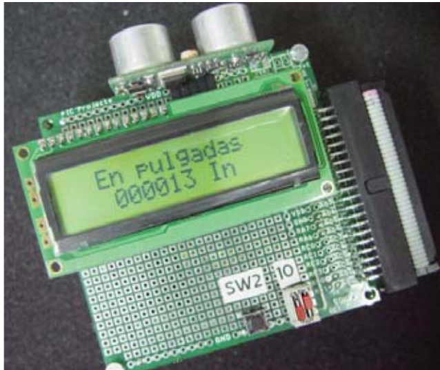
Fig.20 El programa SFR08_TEST comprueba el correcto funcionamiento del módulo sonar presentando en la pantalla LCD la medida seleccionada con SW0 y SW1.
