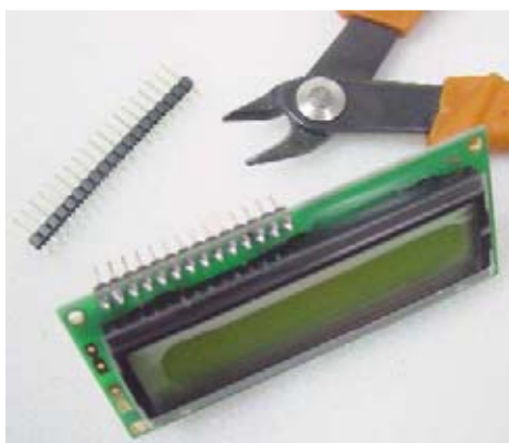
Fig.12 Una tira de 14 pines macho se suelda a la pantalla LCD.
