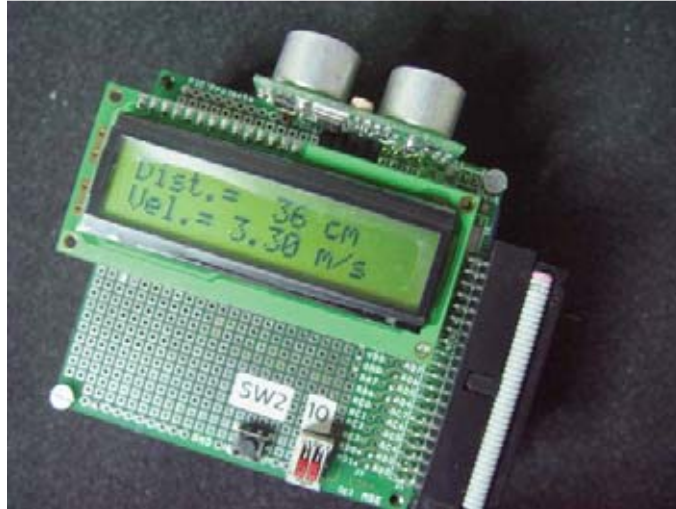
Fig.23 Se simula un radar, visualizando en la pantalla LCD la distancia entre el sonar y el objeto móvil. Cuando se supera una velocidad límite se genera una señal acústica y se visualiza en la pantalla la velocidad causante de la alarma.
