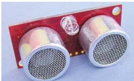
Fig.5 Fotografías obtenidas por la parte delantera del módulo ultrasónico SFR08.
