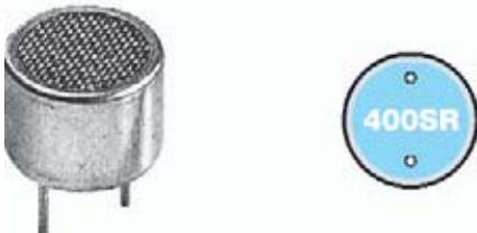
Fig.2 En el reverso de la cápsula RECEPTORA se encuentra serigrafiada la referencia 400SR.
