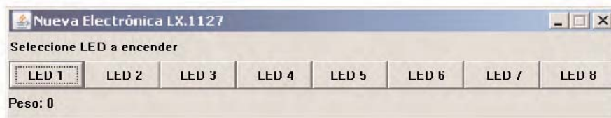
Fig.2 El lenguaje de programación Java permite construir con mucha facilidad interfaces gráficas de usuario (GUI - Graphical User Interface). Aquí se muestra el aspecto de la interfaz definida en el programa GuiLX1127 bajo sistema operativo Windows.
