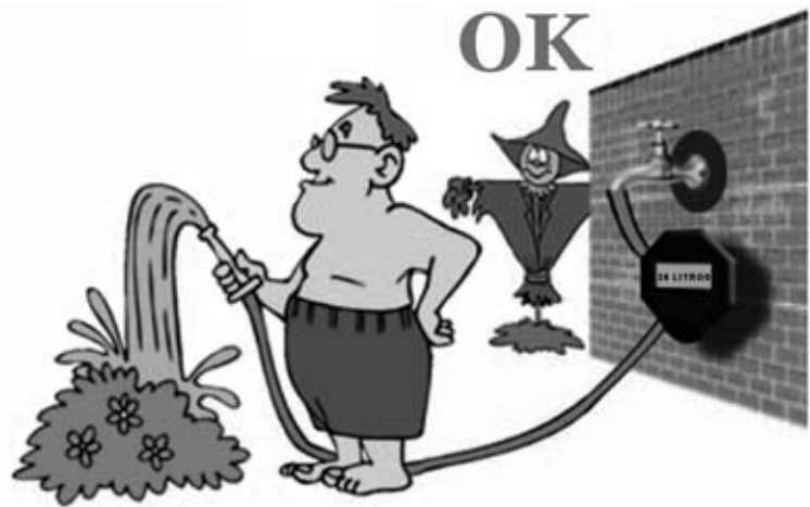
Fig.3 Conectado el flujómetro en serie al grifo del jardín siempre se dispensará a las plantas una cantidad precisa de agua. De esta forma las plantas tendrán el agua justa, evitando además inútiles derroches.
