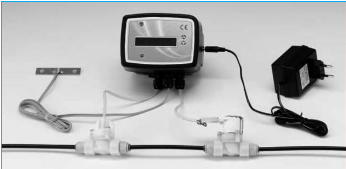
Fig.1 Conectando nuestro flujómetro a un contador y a una electroválvula se pueden realizar irrigaciones muy precisas, tanto con agua como con cualquier otro tipo de líquido. En el display se visualiza el volumen suministrado (en litros), el caudal (en litros por minuto) y el número de ciclos de irrigación realizados. El flujómetro se proporciona montado en un contenedor impermeable, con protección clase IP42 y con certificación CE.
