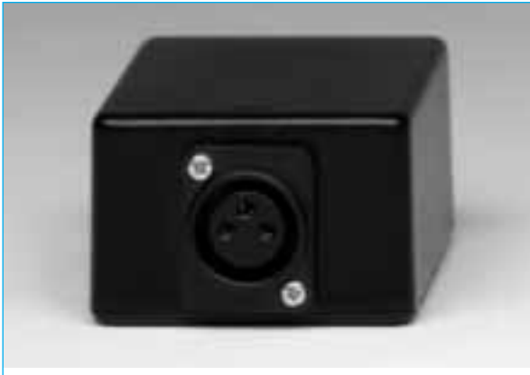
Fig.15 Fotografía del mueble visto por el lado del conector hembra XLR con señal balanceada. El mueble se proporciona perforado.
