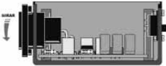
Fig.9 Girando el conector los componentes del circuito impreso quedarán orientados hacia la parte superior. Es el momento de soldar al impreso los cables procedentes del interruptor y del portapilas.
