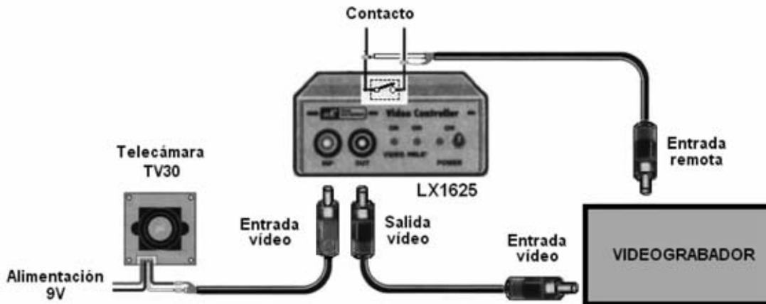
Fig.3. Esquema de conexión de un control Presencial con videocámara.
