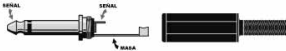
Fig.6 En los conectores jack mono de 6,3 mm la señal BF se aplica al contacto interior, mientras que la masa se aplica al cilindro exterior.
