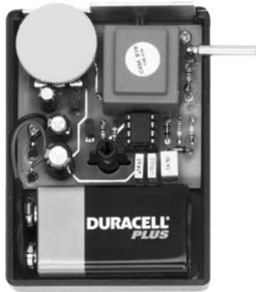
Fig.7 Después de montar todos los componentes en el circuito impreso LX.1621 se puede fijar en el mueble de plástico, junto a la pila de 9 voltios. Para que puedan salir tanto el puntal de aplicación como la chincheta de masa hay que hacer sendos agujeros en el mueble. Para obtener un mejor contacto entre el dispositivo y el cuerpo se puede humedecer ligeramente el dedo utilizado para tocar la chincheta de masa.
