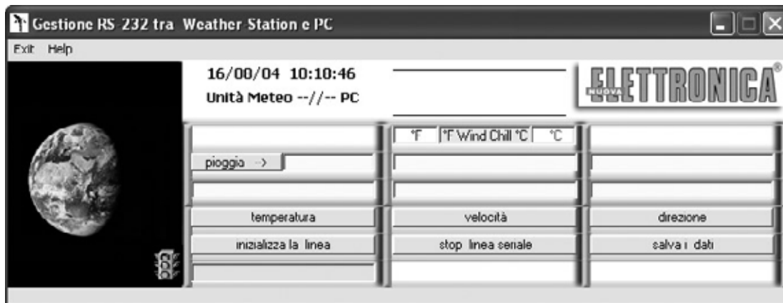
Fig.18 Este es el aspecto de la ventana principal del programa. Para activar la comunicación serie hay que inicializar la comunicación eligiendo el puerto serie al que se ha conectado la centralita. Para realizar esta operación hay que pulsar en INICIALIZAR LÍNEA (inizializza la linea).
