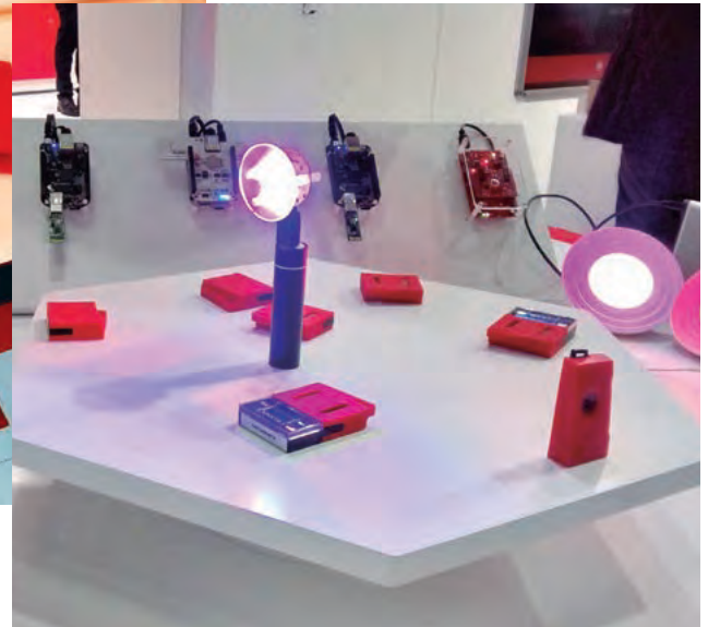
SensorTags de TI: módulos multi-sensor con BLE integrado.
