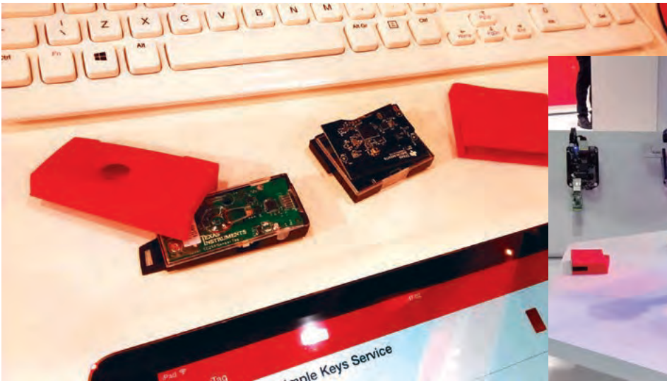
SensorTags de TI: módulos multi-sensor con BLE integrado.
