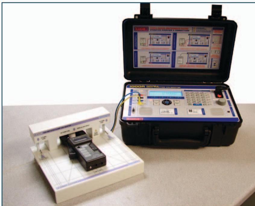
Simula termopares y RTD. Para calibración de medidores de temperatura.
