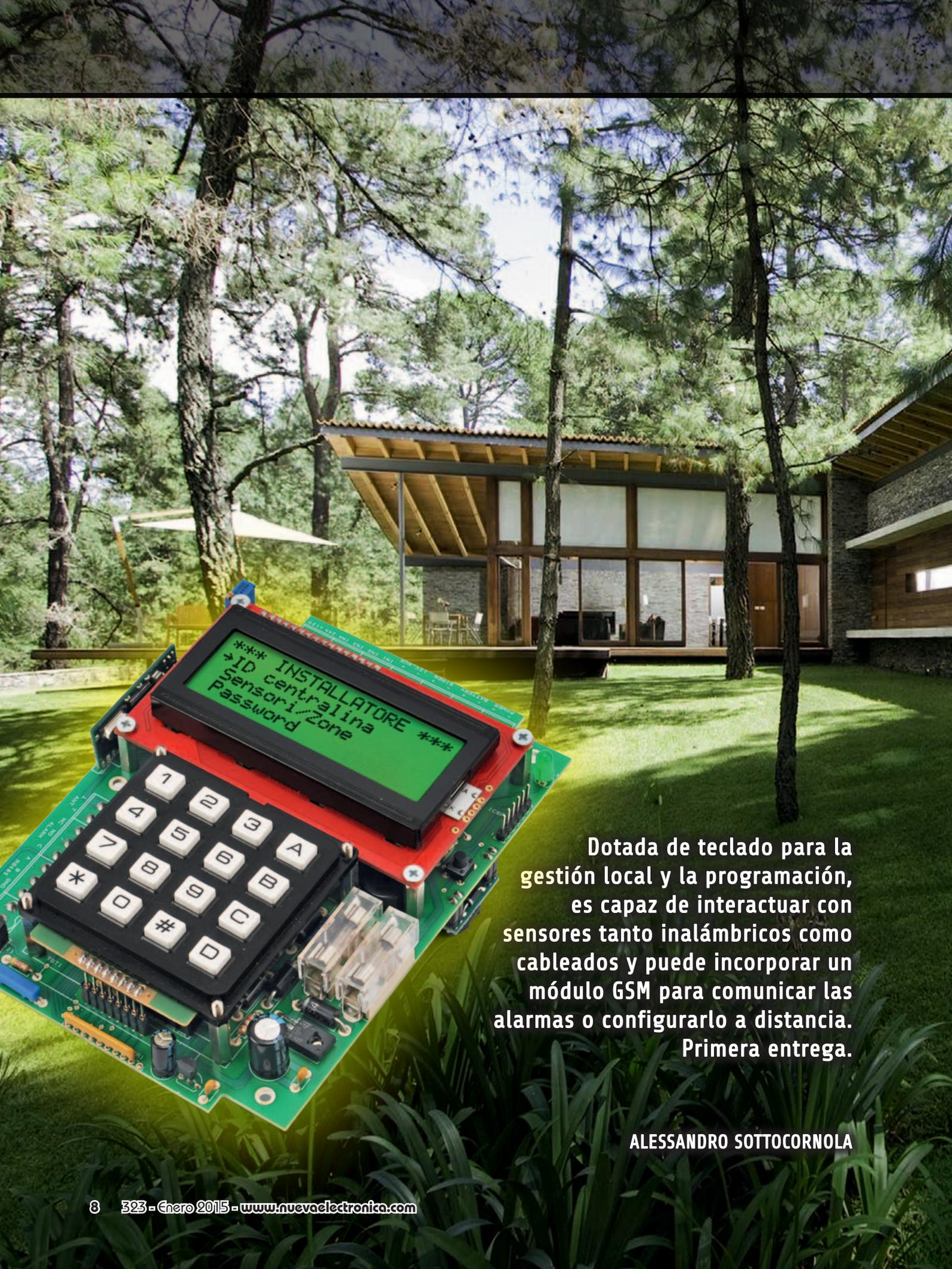
**Dotada de teclado para la gestión local y la programación, es capaz de interactuar con sensores tanto inalámbricos como cableados y puede incorporar un módulo GSM para comunicar las alarmas o configurarlo a distancia. Primera entrega.**
