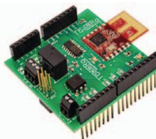
Con este shield dotamos a Arduino de conexión wireless basándonos en el transceptor de RF MRF24J40MA compatible
