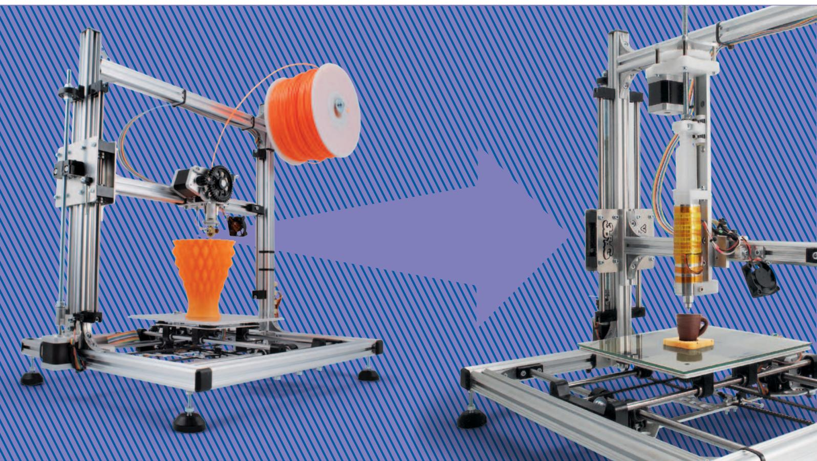
remos como modificar la 3Drag para que imprima objetos con chocolate fundido; próximamente, además, publicaremos los proyectos de dos simples accesorios: el caliente jeringas (para mantener calientes las "recargas de chocolate" para tenerlas listas al momento de montarlas en la máquina, para poder trabajar más rápido) y el sistema de enfriamiento del chocolate, del cual en breve explicaremos su utilidad.
