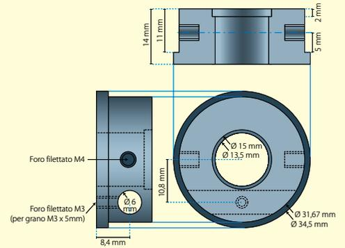
*Diseños mecánicos de dimensiones de las piezas metálicas que componen el kit de modificación; la correa y la guía son productos IGUS que se compran ya listos (en la guía se realizan agujeros adicionales, como se indica aquí a la izquierda).*
