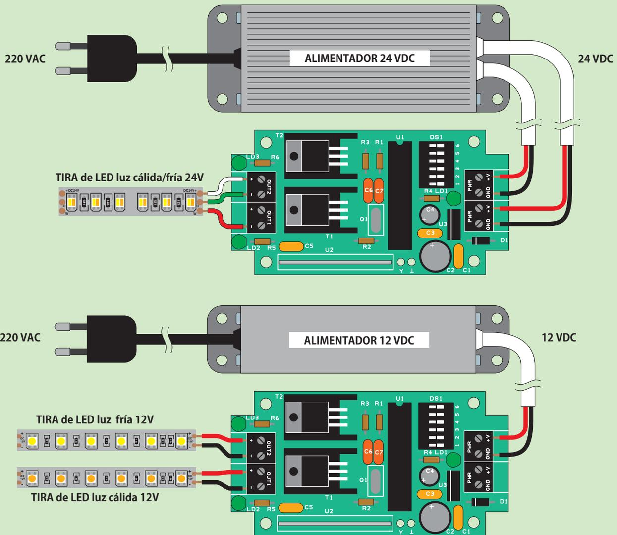
Cómo conectar el circuito del controlador/receptor a la fuente de alimentación y a las tiras de LED: arriba está ilustrado el cableado con una tira único de dos filas de LEDs (blanco caliente y blanco frío) y tres hilos, donde las filas de diodos luminosos funcionan cada una a 24 voltios; por consiguiente la fuente de alimentación a utilizar es de 24 Vcc. El ejemplo se refiere a una tira de LEDs configurados con ánodo común,
