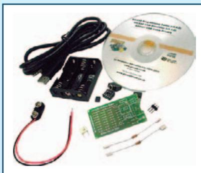
cable especial de comunicación con el ordenador, componentes, un Picaxe 08M2 y CD con el software, manuales y ejemplos del equipo.
