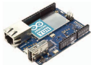
Arduino es una plataforma de hardware libre, basada en una placa con un microcontrolador y un entorno de desarrollo, diseñada para facilitar el uso de la electrónica en proyectos multidisciplinares.
