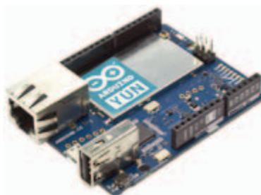
Arduino es una plataforma de hardware libre, basada en una placa con un microcontrolador y un entorno de desarrollo, diseñada para facilitar el uso de la electrónica en proyectos multidisciplinarios. Elige la que más se ajuste a las necesidades de tu aplicación; entradas/salidas, conectividad, memoria, ...
