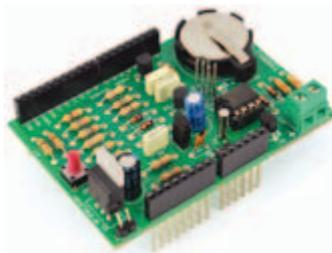
Optimizamos la autonomía de los sistemas Arduino alimentados por batería, gracias a un temporizador basado en RTC con función despertador programable.
