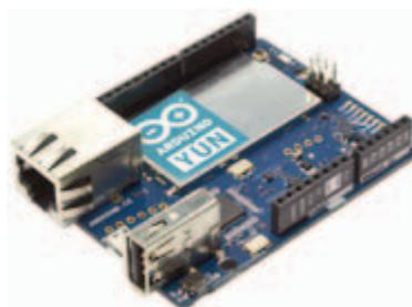
Arduino es una plataforma de hardware libre, basada en una placa con un microcontrolador y un entorno de desarrollo, diseñada para facilitar el uso de la electrónica en proyectos multidisciplinarios.
