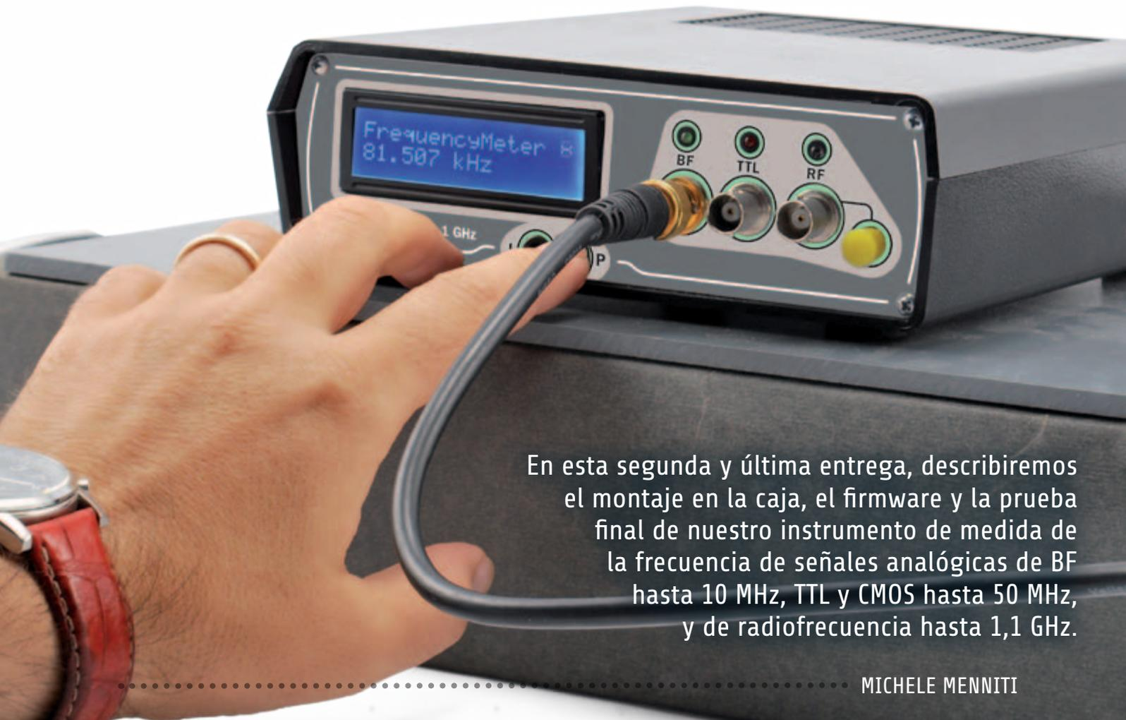
En esta segunda y última entrega, describiremos el montaje en la caja, el firmware y la prueba final de nuestro instrumento de medida de la frecuencia de señales analógicas de BF hasta 10 MHz, TTL y CMOS hasta 50 MHz, y de radiofrecuencia hasta 1,1 GHz.
