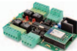
Basado el nuevo módulo Bluetooth RN-42 de Roving Network, esta tarjeta de 4 canales se convierte en un sistema de telecontrol basado en Android (Android Based). Se trata de una tarjeta de gestión de entradas/salidas provista de cuatro salidas a relé y otras tantas entradas opto-aisladas a nivel de tensión, controlables a través de Bluetooth.
