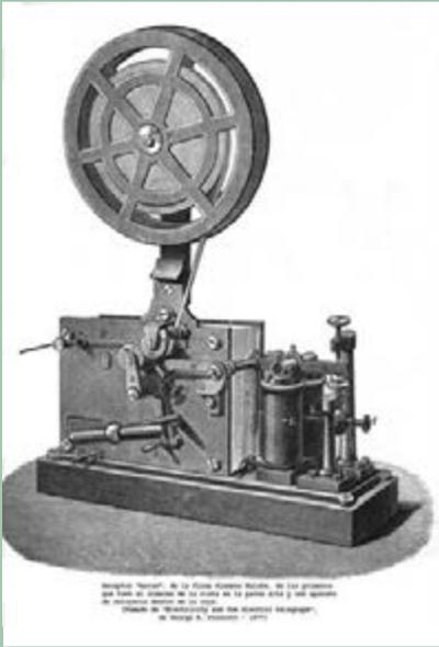
Figura 26.- Receptor "morse".- Tomado de "La telegrafía actual en Francia y en el extranjero", de L. Montillot, de 1891.
