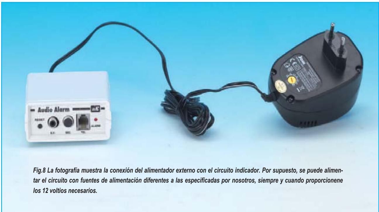
*Fig.8 La fotografía muestra la conexión del alimentador externo con el circuito indicador. Por supuesto, se puede alimentar el circuito con fuentes de alimentación diferentes a las especificadas por nosotros, siempre y cuando proporcionene los 12 voltios necesarios.*
