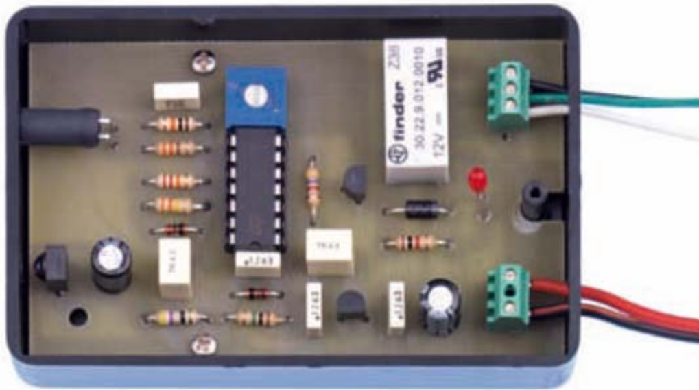
Fig.8 en esta foto podéis ver el circuito impreso montado e introducido en el interior del mueble de plástico que os suministramos con el kit.
