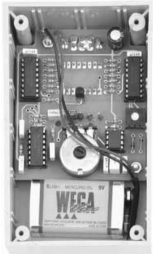
Fig.9 foto del circuito montado e introducido dentro del mueble. Debajo se puede ver el hueco destinado al alojamiento de la pila de 9 V, garantizando la autonomía del circuito.
