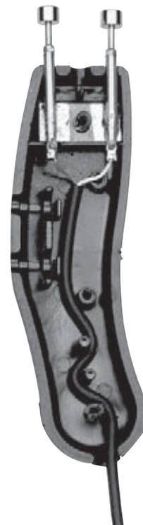
Fig.7 en ese dibujo se representa la secuenciación del montaje del skin detector dentro del contenedor de plástico. En la parte superior de la carcasa hay una pequeña ventana rectangular, que es donde se coloca la parte frontal del microamperímetro.
