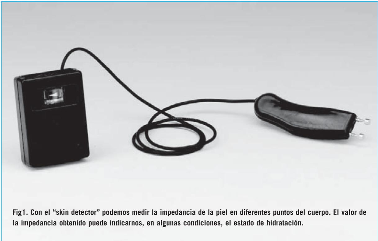
Fig1. Con el "skin detector" podemos medir la impedancia de la piel en diferentes puntos del cuerpo. El valor de la impedancia obtenido puede indicarnos, en algunas condiciones, el estado de hidratación.
