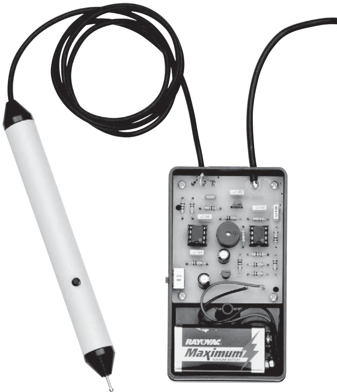
Fig.10 foto de uno de los circuitos con el que realizamos las pruebas. Detrás de la carcasa de plástico hay dos orificios: en uno se introduce el cable pelado que va a la punta, soldando cuidadosamente los tres terminales en sus lugares correspondientes; en el otro, el cable de conexión que va en contacto con la masa, llevado a cabo por una ventosa o pinza.
