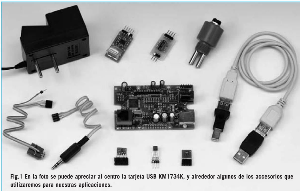
Fig.1 En la foto se puede apreciar al centro la tarjeta USB KM1734K, y alrededor algunos de los accesorios que utilizaremos para nuestras aplicaciones.
