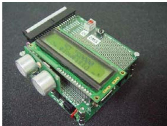
Fig.17 En la parte superior se aprecia la PIC'PROJECT con el módulo SFR08 y la pantalla LCD. La tarjeta PIC'CONTROL se encuentra debajo sujeta a la anterior mediante separadores.
