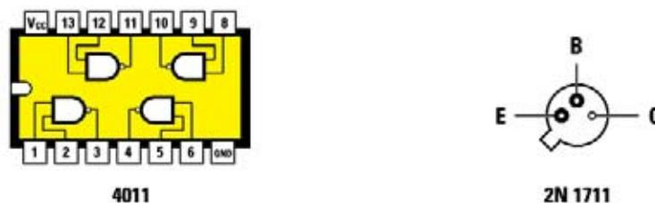
Fig.2 Conexiones del integrado CMOS 4011 y del transistor NPN 2N1711. También se muestra la lista de componentes completa.
