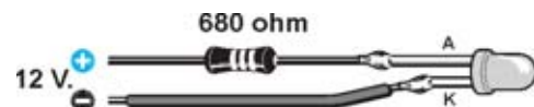
Fig.5 Para alimentar un diodo LED rojo con una tensión de 12 voltios es necesaria una resistencia de 680 ohmios.
