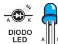
Fig.1 Los diodos LED disponen de dos terminales, ánodo (A) y cátodo (K). El terminal más largo (ánodo) se conecta a la tensión positiva, mientras que el terminal más corto (cátodo) siempre va conectado al negativo de alimentación.
