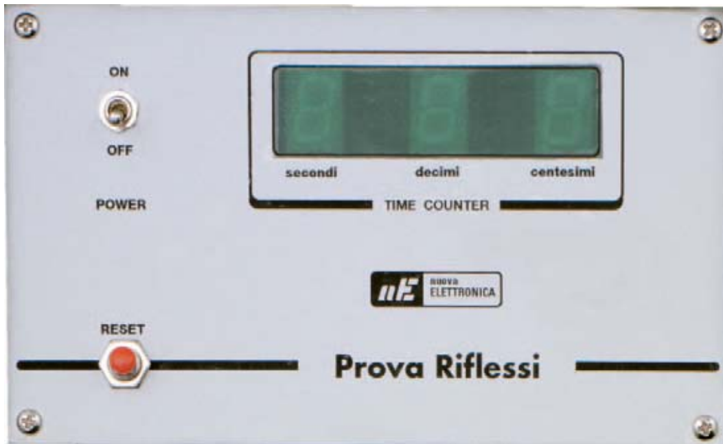
Fig.12 El panel frontal del mueble se proporciona perforado y serigrafiado. La ventana central del display dispone de un protector de color verde.
