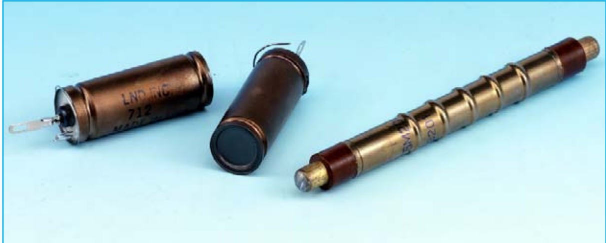
Fig.1 El nuevo Contador Geiger LX.1710 utiliza el tubo LND 712, sensible a radiaciones alfa, beta y gamma. Se trata de un tubo fabricado en Estados Unidos ampliamente difundido. No obstante quienes deseen utilizar el viejo tubo SBM 20 de fabricación rusa, sensible a radiaciones beta y gamma, también pueden utilizarlo ya que el contador está diseñado para soportar ambos sensores.
