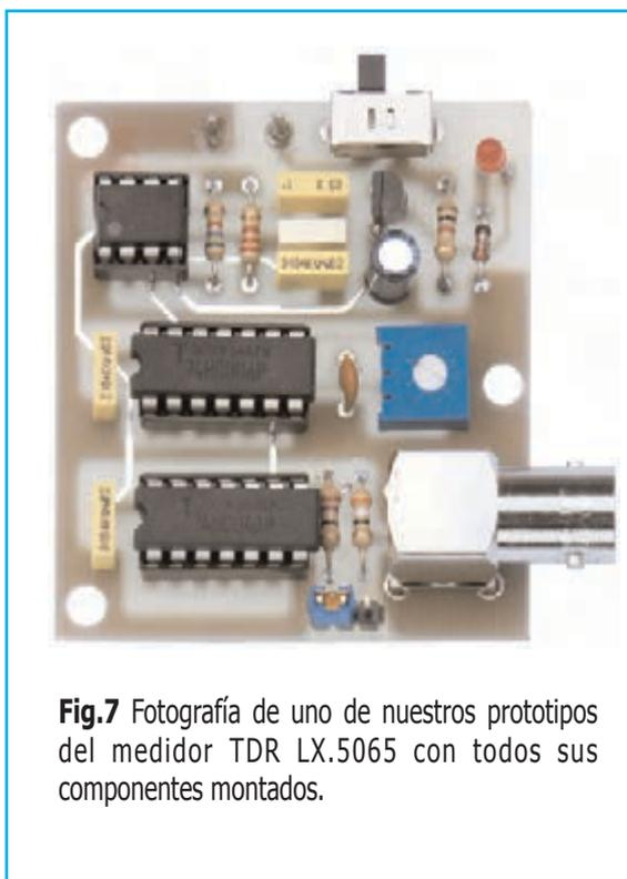
**Fig.7** Fotografía de uno de nuestros prototipos del medidor TDR LX.5065 con todos sus componentes montados.
