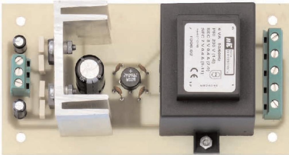
**Fig.11** Fotografía de uno de nuestros prototipos de la etapa de alimentación LX.1701 (parte superior) y esquema práctico de montaje (parte inferior). La clema de la izquierda y la clema de dos polos de la derecha se utilizan para conectar, mediante cables, la tarjeta LX.1700 (ver Fig.18). El interruptor de encendido (S1) se monta directamente en la tarjeta base LX.1700 (ver Fig.12).
