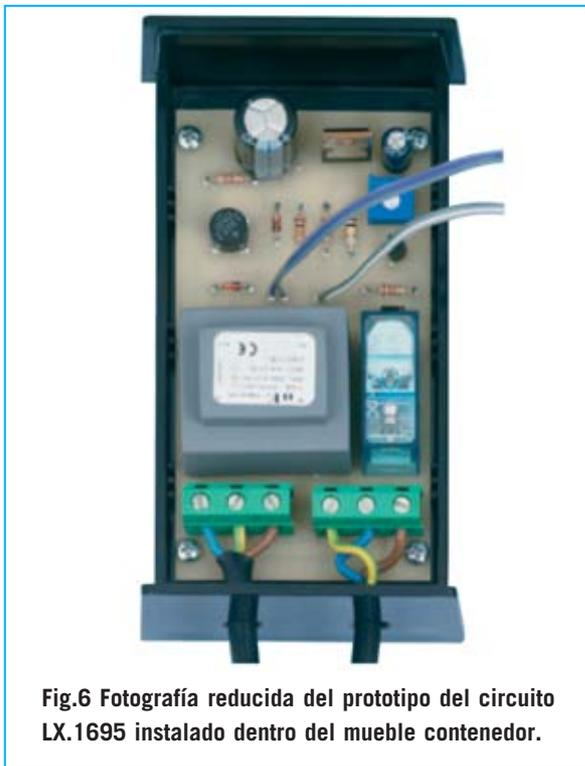
Fig.6 Fotografía reducida del prototipo del circuito LX.1695 instalado dentro del mueble contenedor.
