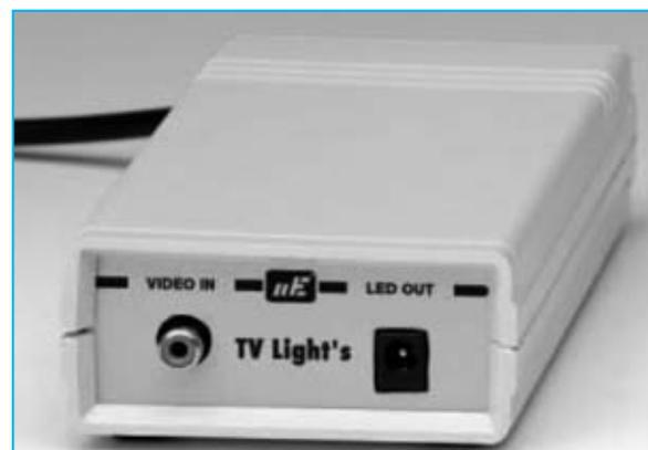
Fig.7 En la toma RCA del panel frontal se conecta el cable con la señal de vídeo procedente del televisor. Del conector de alimentación situado a la derecha se obtiene la señal que alimenta las barras de diodos LED.
