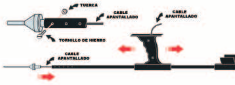
Fig.7 Una vez ensamblado el puntal, incluyendo la cápsula piezoeléctrica, se puede proceder al montaje del resto de elementos mecánicos, esto es, el mástil, la empuñadura y el reposabrazos. Antes de realizar las operaciones es muy aconsejable realizar una atenta lectura de las descripciones detalladas en el artículo.
