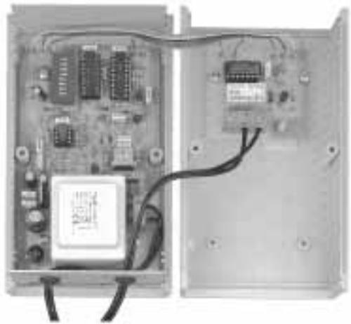
**Aspecto final de los circuitos LX.1502 y LX.1502/B con todos sus componentes montados e instalados dentro de su mueble contenedor, incluido en el kit.**
