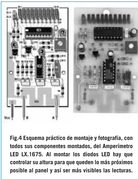
Fig.4 Esquema práctico de montaje y fotografía, con todos sus componentes montados, del Amperímetro LED LX.1675. Al montar los diodos LED hay que controlar su altura para que queden lo más próximos posible al panel y así ser más visibles las lecturas.
