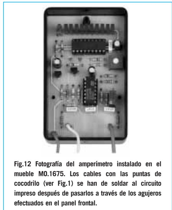
Fig.12 Fotograf a del amper metro instalado en el mueble MO.1675. Los cables con las puntas de cocodrilo (ver Fig.1) se han de soldar al circuito impreso despu s de pasarlos a trav s de los agujeros efectuados en el panel frontal.
