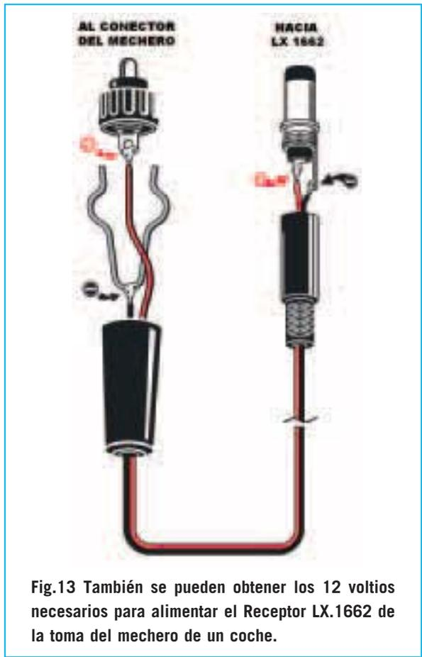
Fig.13 También se pueden obtener los 12 voltios necesarios para alimentar el Receptor LX.1662 de la toma del mechero de un coche.
