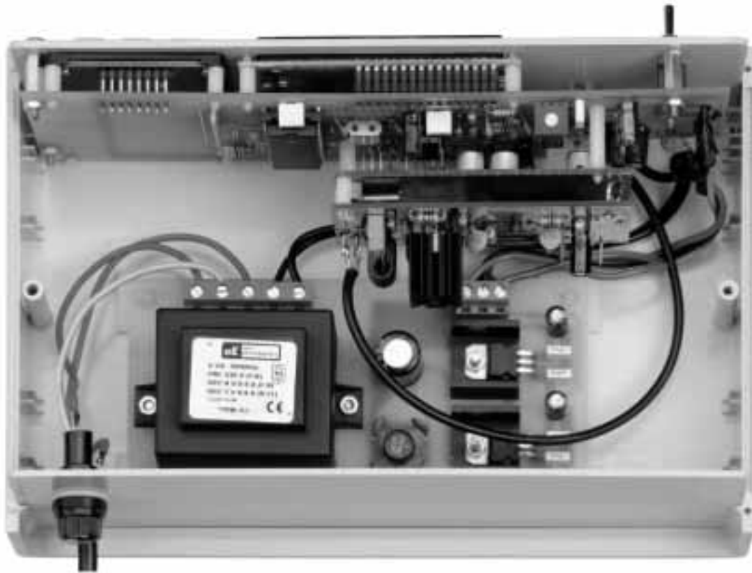
Fig.12 Fotografía del interior de nuestro Generador DDS. En el caso de que resulte complicada la solución mostrada en la Fig.11 se puede montar el circuito impreso LX.1663 en el espacio disponible en la parte derecha del mueble.
