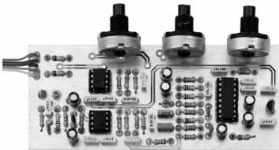
Fig.22 Fotografía de la tarjeta Eco y entrada micrófono. Esta tarjeta se instala perpendicularmente en la parte interior del panel frontal del mueble (ver Fig.27).
