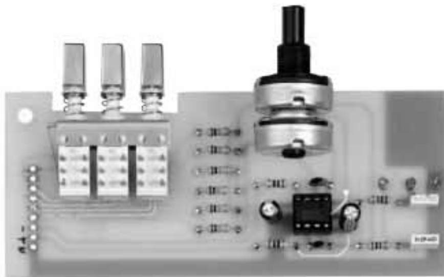
Fig.24 Tarjeta de Pre-escucha LX.1673. Los 3 pulsadores del conmutador, el potenciómetro de volumen y el conector jack de los auriculares se instalan en el lado derecho del panel frontal del Mezclador (ver Fig.13).
