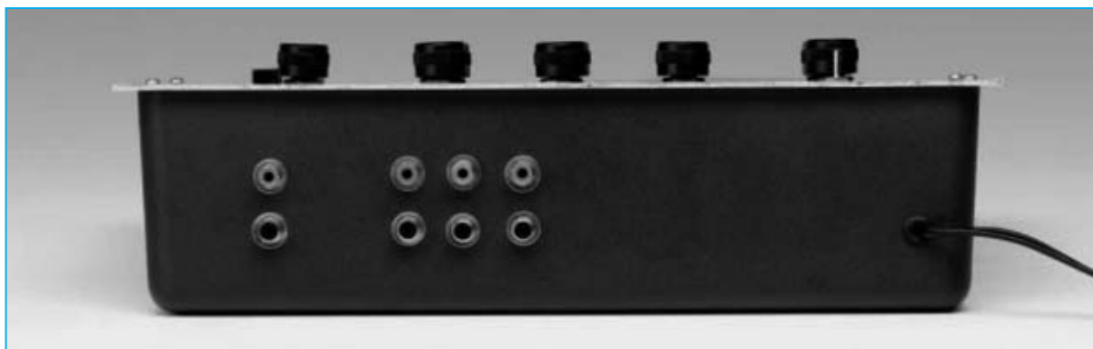
Fig.12 Fotografía del mueble contenedor del Mezclador visto por el lado posterior. A la izquierda se encuentran los dos conectores RCA correspondientes a la salida BF y, casi en el centro, los 6 conectores RCA correspondientes a los 3 canales estéreo de entrada (CH1-CH2-CH3).
