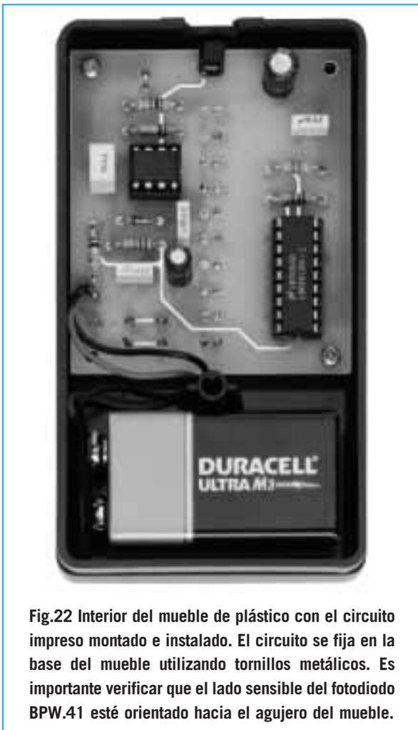
Fig.22 Interior del mueble de plástico con el circuito impreso montado e instalado. El circuito se fija en la base del mueble utilizando tornillos metálicos. Es importante verificar que el lado sensible del fotodiodo BPW.41 esté orientado hacia el agujero del mueble.
