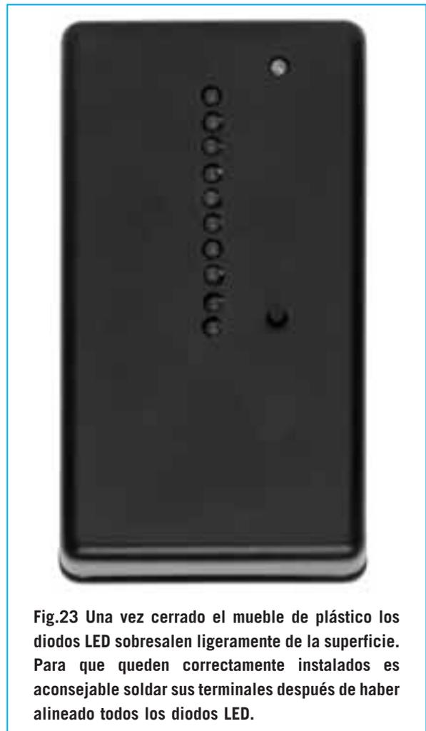
Fig.23 Una vez cerrado el mueble de plástico los diodos LED sobresalen ligeramente de la superficie. Para que queden correctamente instalados es aconsejable soldar sus terminales después de haber alineado todos los diodos LED.
