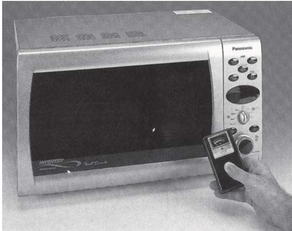
Esquema de montaje práctico de la placa LX.1517. Para comprobar si un horno microondas tiene fugas de SHF hay que desplazar el aparato a lo largo del perímetro de la puerta y por los cierres.
