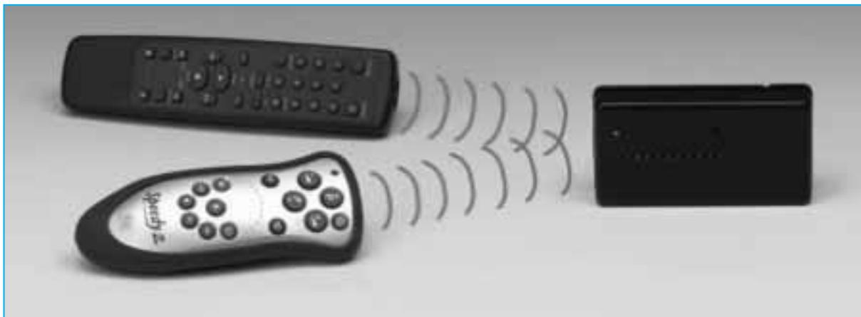
Fig.24 Para controlar si funciona correctamente el Detector de rayos infrarrojos LX.1658 solo hay que utilizar un mando a distancia de rayos infrarrojos y ponerlo a unos 10 cm del agujero del fotodiodo BPW.41. Actuando sobre el pulsador P1 y sobre las teclas del mando a distancia varios diodos LED rojos se encenderán. Cuanto más se separe el mando a distancia menos diodos LED rojos se encenderán.
