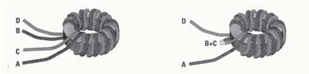
Realización y aspecto del transformador con núcleo toroidal T1.
