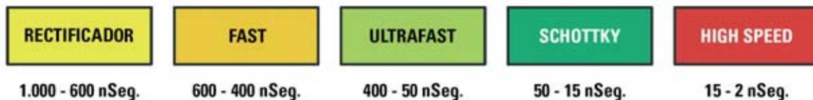
Fig.1 Los diodos menos rápidos tienen una velocidad de conmutación entre 600 y 1.000 nanosegundos, siendo comúnmente utilizados para rectificar la tensión de red de 50 Hertzios, mientras que los más rápidos (High Speed) pueden alcanzar velocidades de conmutación entre 2 y 12 nanosegundos.
